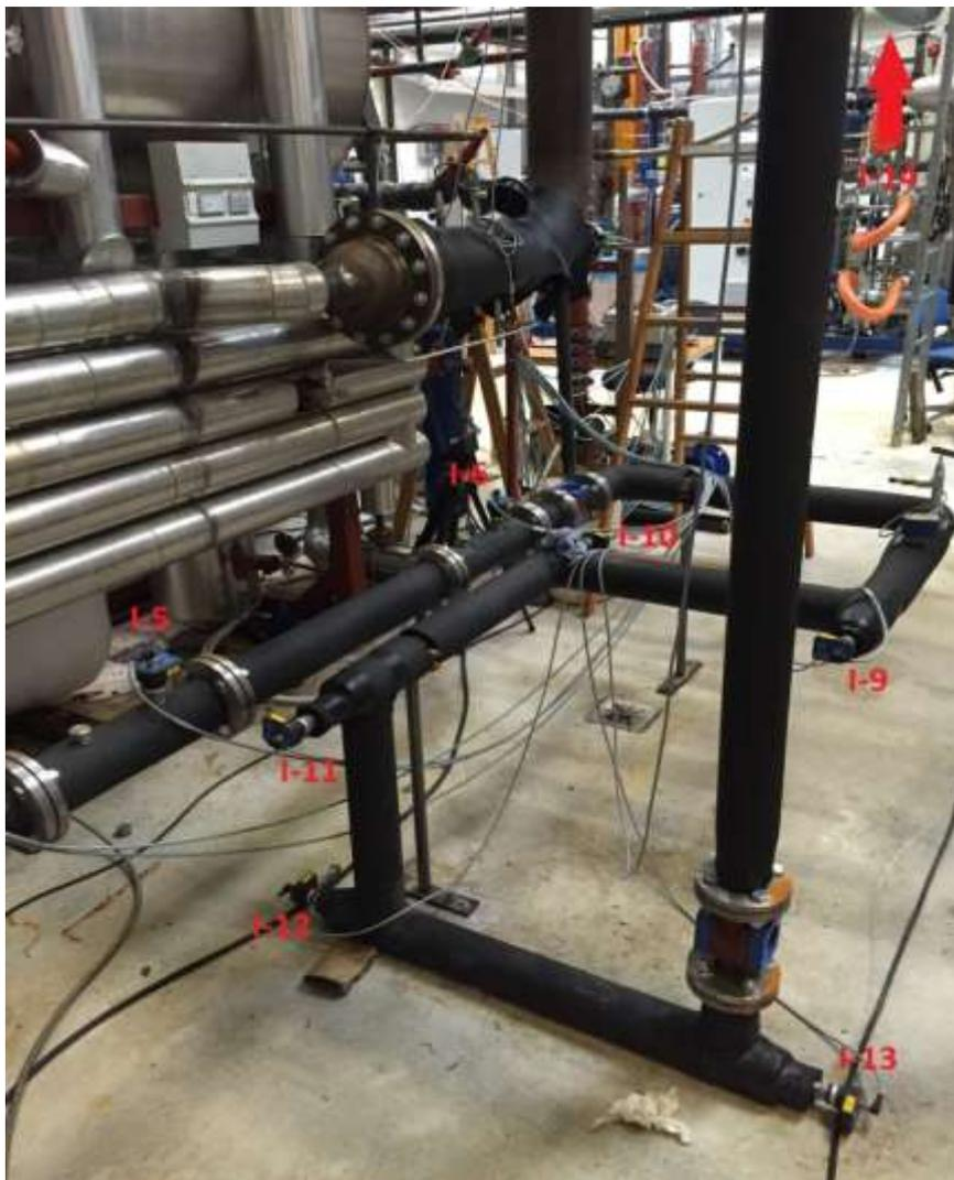
*Fejl! Henvisningskilde ikke fundet. 13: The sensor mounting on the Laboratory test system.*
